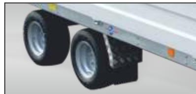
10" Schwerlastbereifung für niedrige Auffahrhöhe
