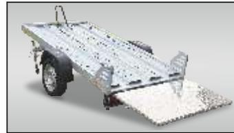
KD-MU-T3 mit 3 Lochblechstahlprofilen und 1 Haltebügel, sowie Stoßdämpfer für sanften Klappvorgang
