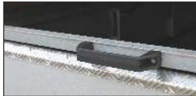
Griff zum Öffnen des Deckel (Daches)
