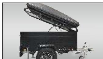
Deckel mit Dachzelt (Zubehör) hochklappbar
