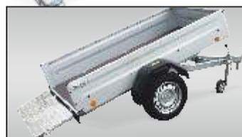
RK-EU2-K Profi mit verstärkter Auffahrklappe bis 450 kg
