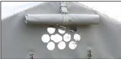
Lüftungslöcher im Planenaufbau
